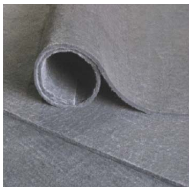
Figur 4.2 I bilden visas aerogel som laminerad isolerings filt. 39
