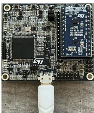
Figur 12 Utvecklingskort STEVAL-MKI109v3 & Modulen STEVAL- MKI217v1 som används under experimentet
