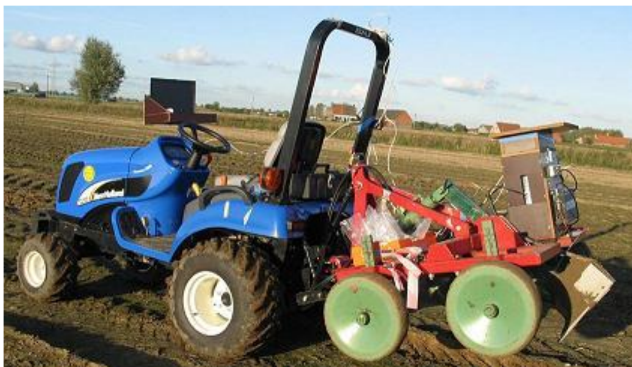
Figur 2 [8] En traktor som styrs med hjälp av adaptiv regulator. (godkänd för publicering av Elektor)
