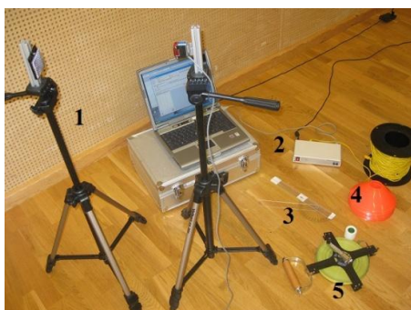
Figur 1. Utrustning som användes vid utvärderingstillfällena var: 1) Fotoceller. 2) Muscle lab. 3) Goniometer. 4) Koner samt 5) Måttband och tejp.
