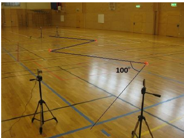
Figur 2. Zigzag-testbana genomfördes i idrottshallen på Högskolan i Halmstad. Varje sträcka i figuren är 5m lång och varje riktningförändring görs med 100 graders vinkel.
