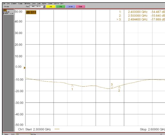
Figur 26: FlexPIFA antenn med PLA plastkapsling
