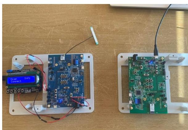
Figur 10: Kommunikationstest mot en trådlös temperatursensor. Till vänster visas Arduino UNO och till höger är utvecklingskortet.
