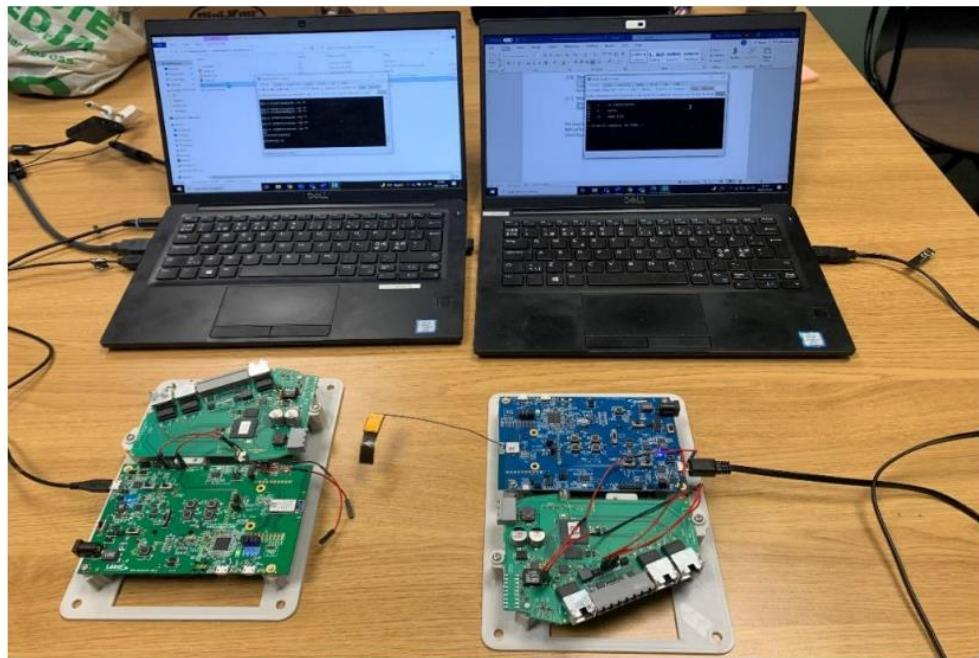
Figur 8: Kommunikationstest mellan två olika BLE-moduler. Ett textmeddelande skickades från ena enhet till den andra
