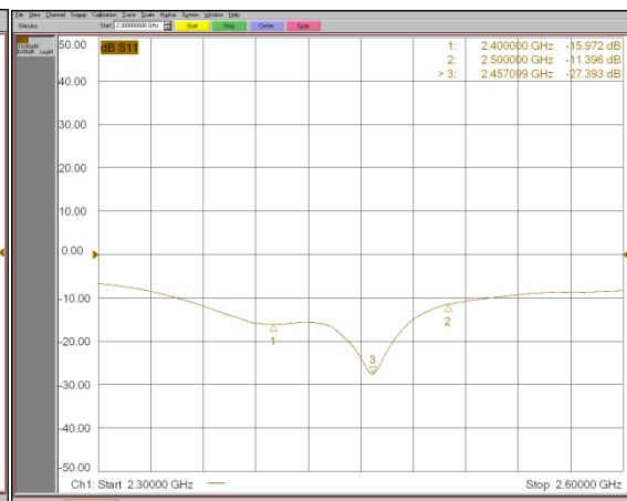
Figur 29: Maglayers PCA antenn med PETG plastkaspling
