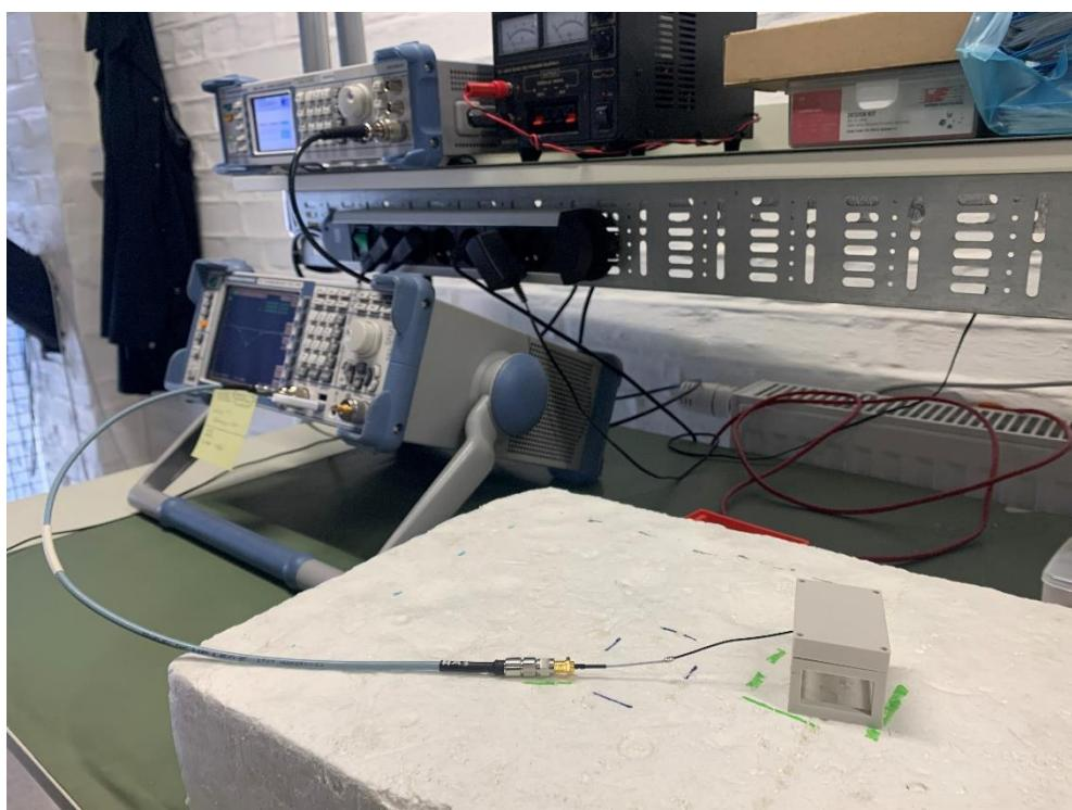
Figur 11: Antennen som sitter i lådan testas med nätverksanalysator
