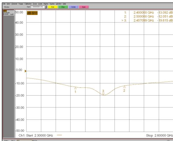
Figur 28: Maglayers PCA antenn med PLA plastkapsling
