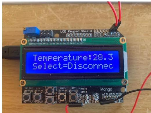
Figur 23: Temperaturvärdet presenteras på LCD skärm
