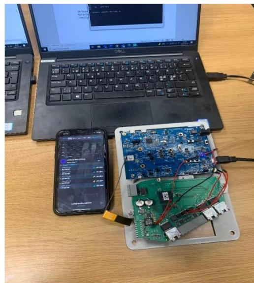
Figur 9: Kommunikationstest mellan en enhet och nRF Connect mobilapplikation. Ett textmeddelande skickas från mobilen till en annan enhet
