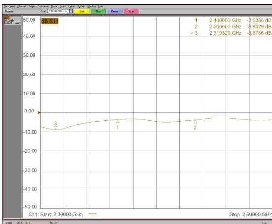
Figur 24: FlexNotch antenn med PLA plastkapsling
