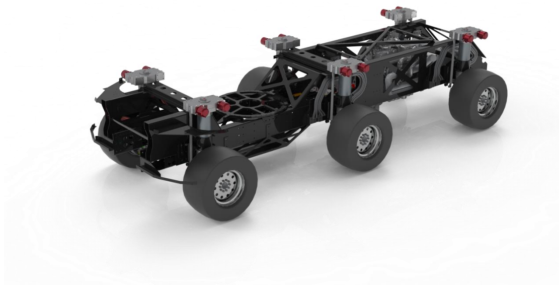
Figur 1, Renderad bild av hur hjulupphängningen kan se ut monterad på en fordonsplattform.
