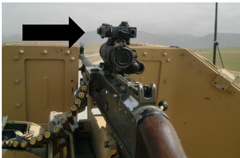
Figur 12 Mörkerriktmedel AK5 monterat på rödpunktssikte monterat på KSP 58 monterad i Ringlavett 09 på en TGB 16. Foto L Bremer
