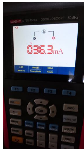
Figur 15: Strömförbruknings mätning med multimeter när Arduion är i viloläge
