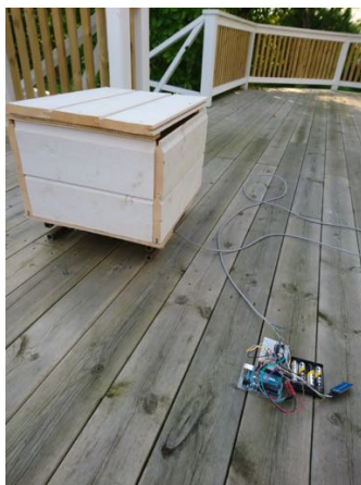
Figur 18: Bild på systemet med bikupa. Tanken är att elektroniken sedan skall ligga i en låda som sitter intill ramen till lastcellen.
